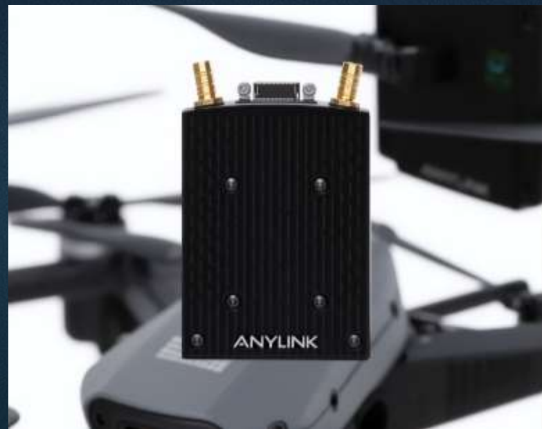
ANYLINK-UAV205WL-J30J/21WL-J30J 无人机图传数据链模块实物展示，紧凑设计，高效散热。
